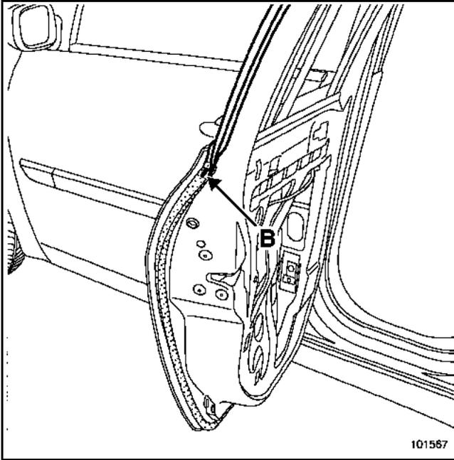
Déclipper l'agrafe supérieure du joint de double étanchéité (B).
