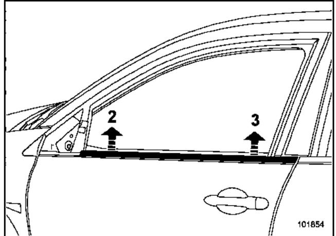
Déposer soigneusement le lécheur (2) et (3) à l'aide de l'outil **Car. 1363**.
