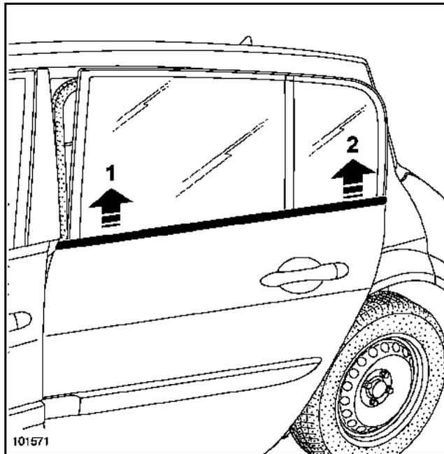
Déposer soigneusement le lécheur extérieur (1) et (2) à l'aide de l'outil **Car. 1363**.
