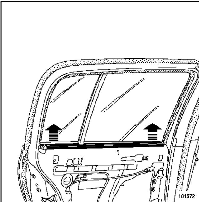
Déposer le lécheur intérieur.
