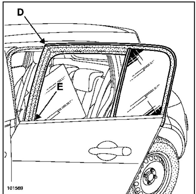
Positionner et chasser le joint à l'angle (D) en prenant soin de le glisser derrière le panneau (E).
