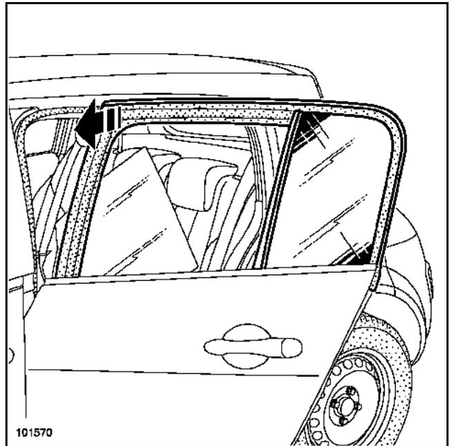
Déclipper la partie avant du joint.
