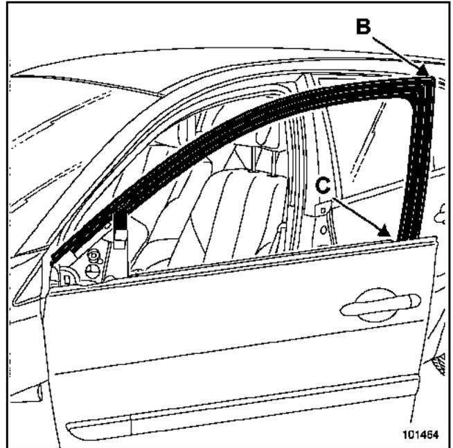
Positionner et chausser le joint à l'angle (B) en prenant soin de le glisser derrière le panneau (C).
