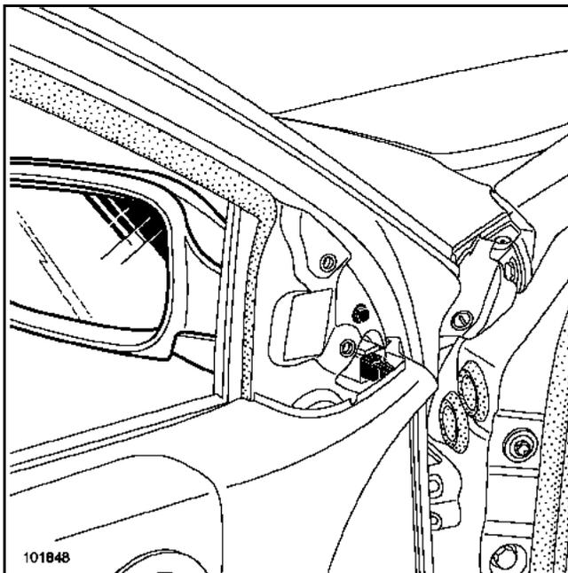
Déposer la vis de maintien du rétroviseur.
