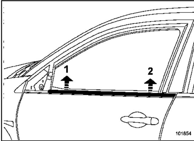
Déposer soigneusement le lécheur (1) et (2) à l'aide de l'outil **Car. 1363**.
