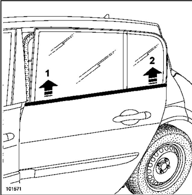
Déclipper le lécheur extérieur (1) et (2) à l'aide de l'outil Car. 1363.
